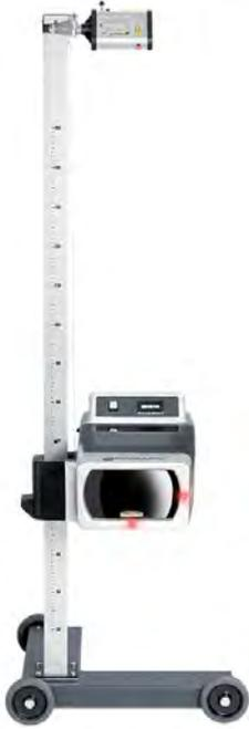
Приборы для измерений параметров света фар автотранспортных средств предназначены для:
