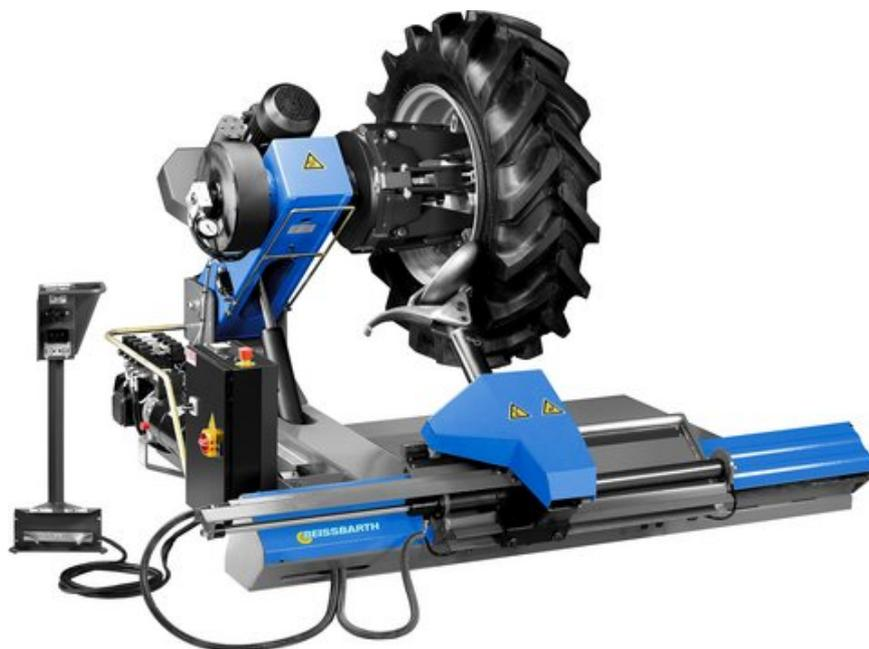
Шиномонтажный станок **BEISSBARTH MS 78** для любых типов колес грузовых автомобилей, тракторов, сельскохозяйственных машин с диаметром дисков до 56" (с дополнительными расширителями). Основной особенностью станка является мобильная консоль управления с джойстиком, который обеспечивает чрезвычайно простую и легкую работу.
