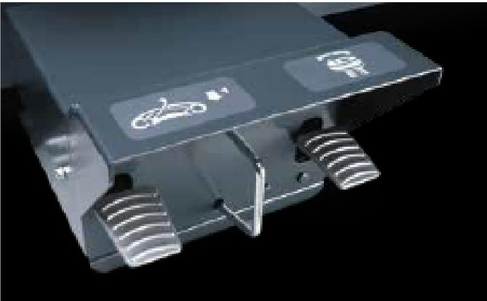
Управление вращением стола и подкачкой производится с педального узла.
