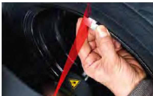
Линейный лазер для фиксации груза на "12 часов"
