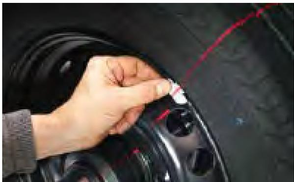
Линейный лазер для точного расположения груза с внешней стороны диска
