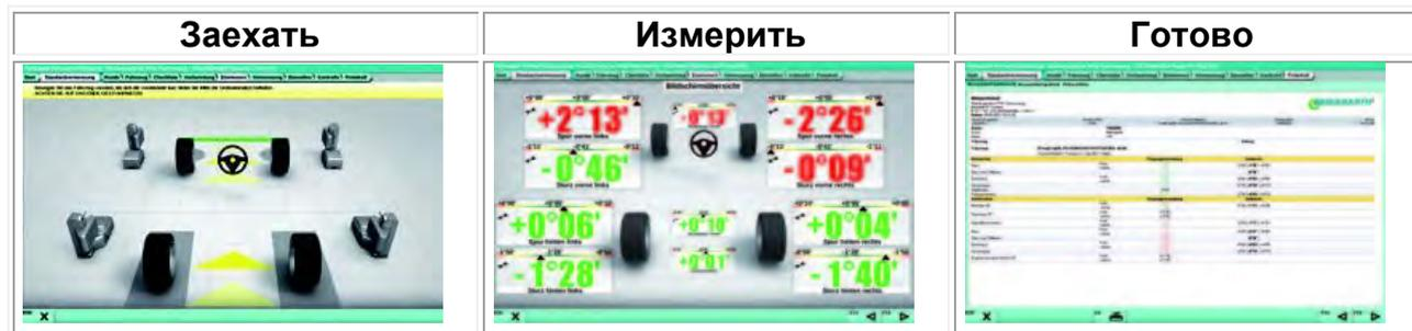
С Touchless бесконтактное измерение углов установки одновременно всех четырех колес становится невероятно точным. За счет простой методики работы с понятным и удобным программным обеспечением и интерфейсом проведение операций по регулировке углов установки колес можно проводить, а даже не покидая автомобиль. Система позволяет обслуживать легковые и легкие коммерческие автомобили с колёсными базами от 1800 до 3750 мм.
